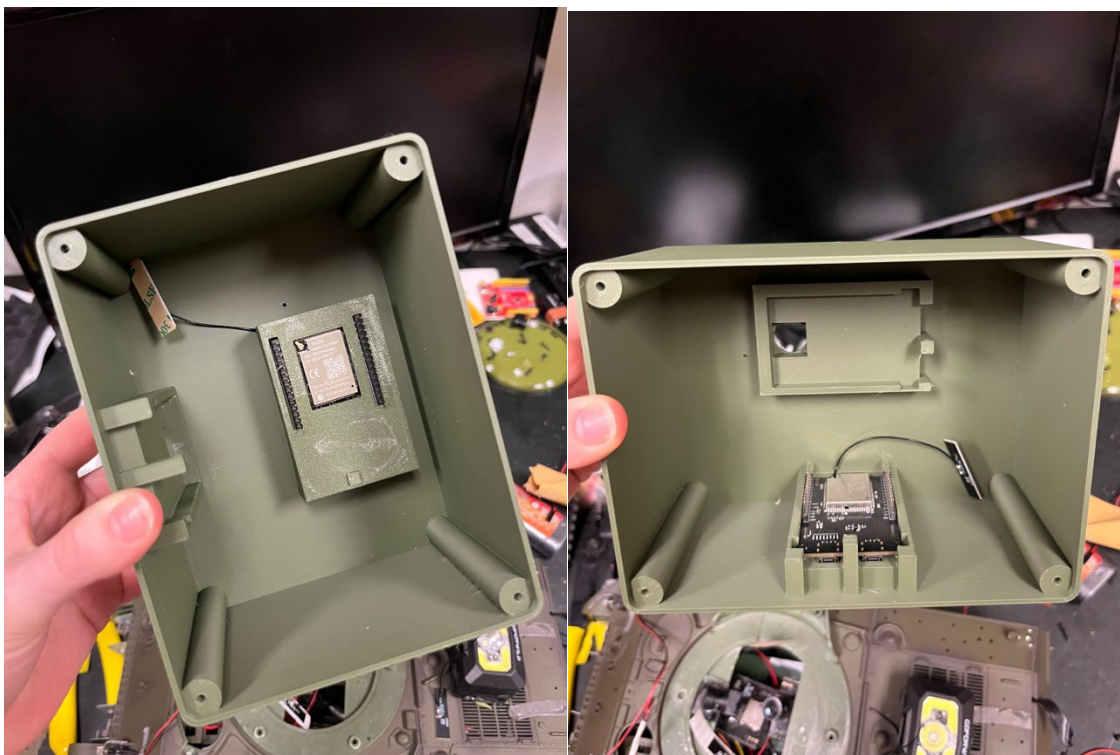
Figure 43 Install AMB 82 board in wall slot
