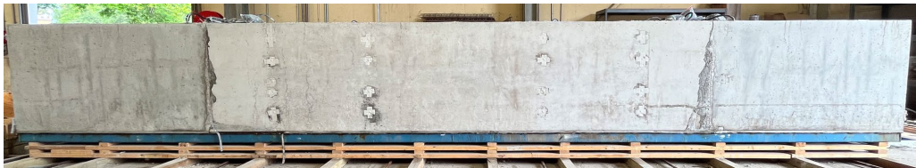
(d) Concrete cast in the exterior section
