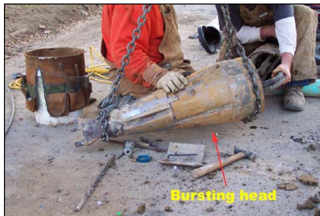
(b) Actual hydraulic bursting head
