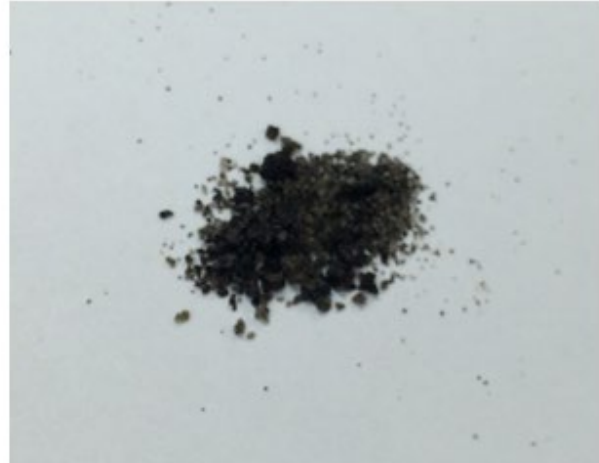
(b) Powder of the slag layer
