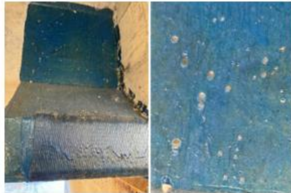
(d) Adhesives with pin holes
