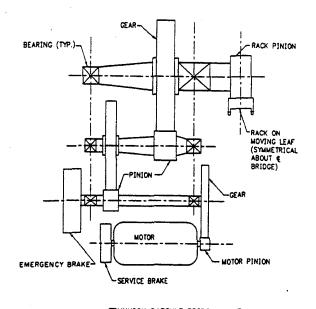
TRUNNION BASCULE BRIDGE DRIVE MACHINERY IS ON THE PIER
