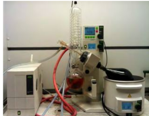
(d) Extraction of binder through rotavapor
