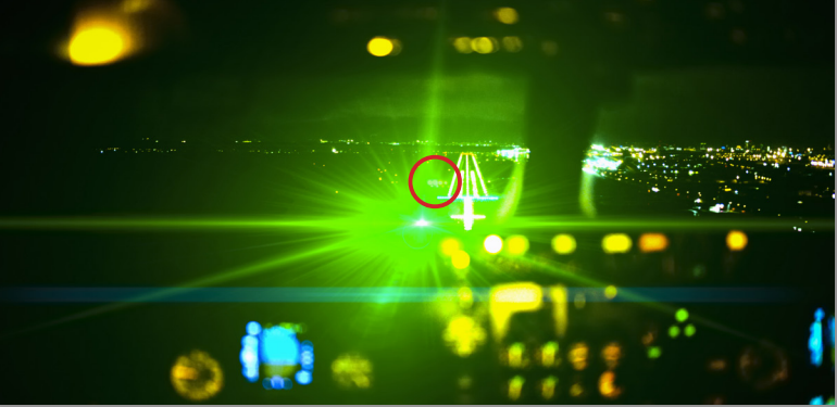
Figura 1: Iluminación láser en un simulador de vuelo, visto de la perspectiva de los pilotos a una milla de distancia sobre el nivel del suelo. El círculo a la derecha del flash contiene luces de la pista.
