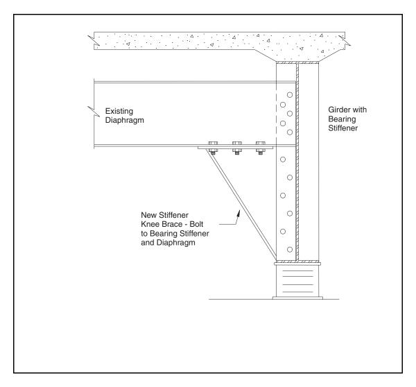
Figure 8-6. Bearing stiffener retrofit.
