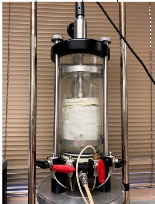
(d) End of triaxial test
