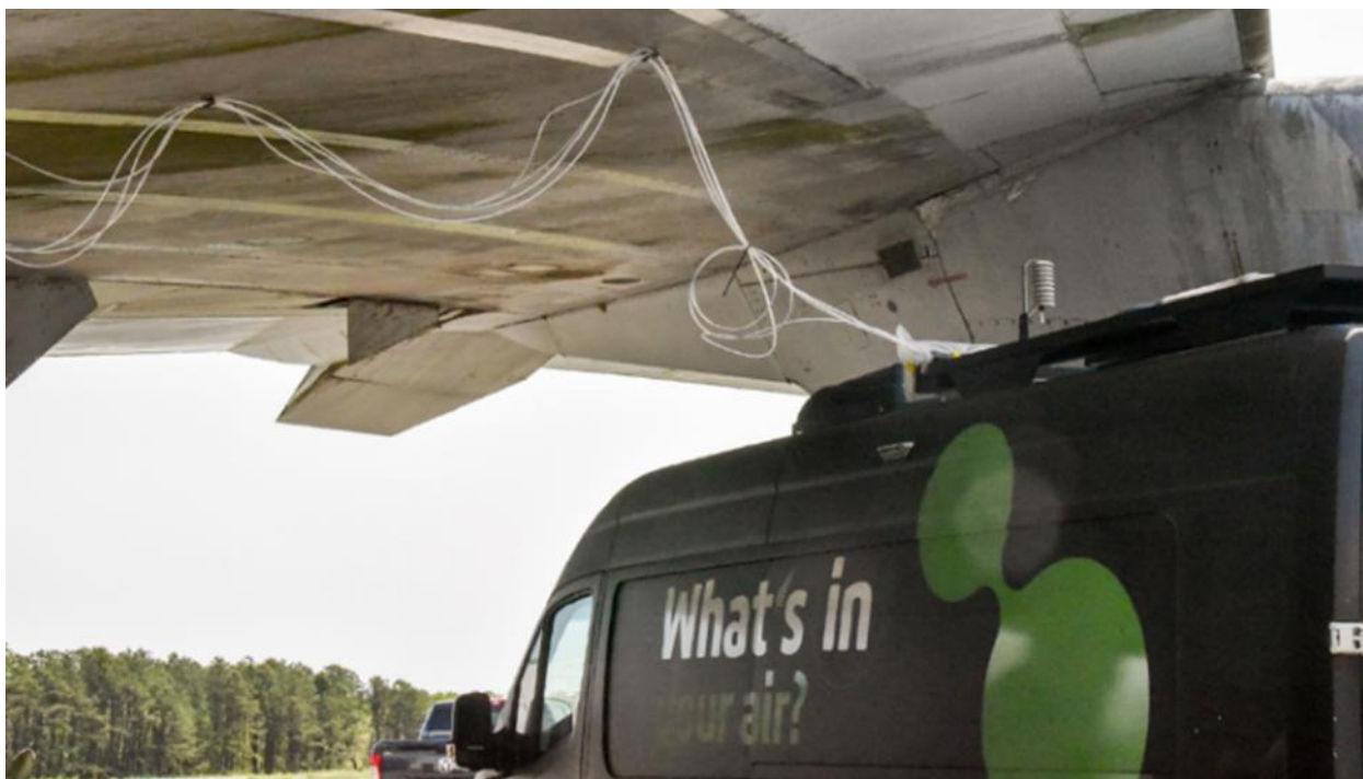
Figure 45. Syft analytics van with 4-reagent ion flow tube mass spectrometer
