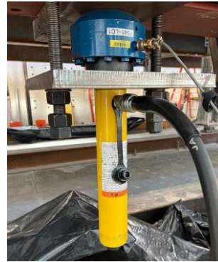
(d) Mounted hydraulic ram and load cell
