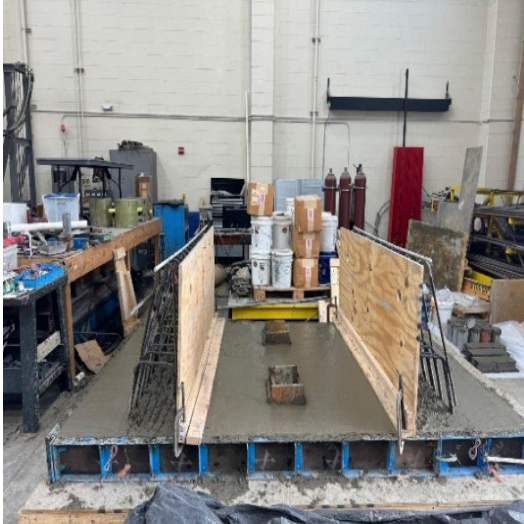
Figure 3.9 Concrete pour (slab)
