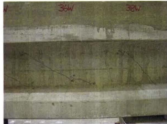
(d) Diagonal Shear Cracks at Load = 219 Kips
