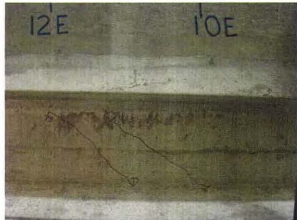
(d) Diagonal Shear Cracks at Load = 245 Kips
