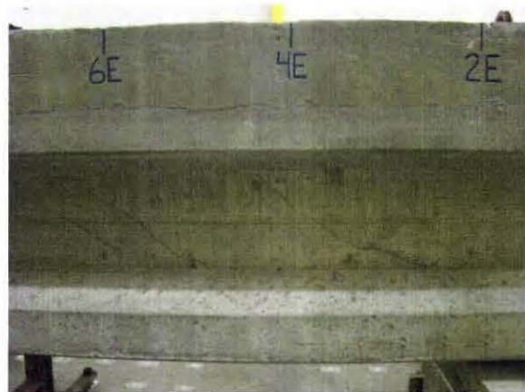
(d) Diagonal Shear Cracks at Load = 235 Kips
