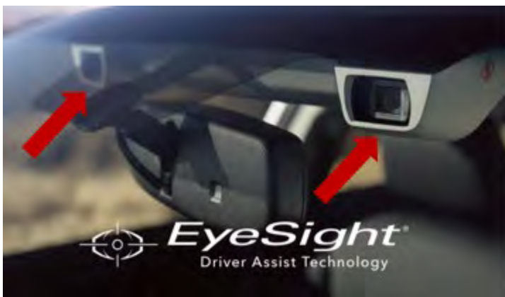
Figure 2. Subaru’s dual ADAS camera system. (Image: Subaru)
