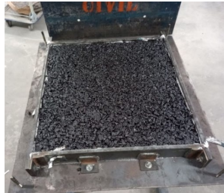
(d) Slab after compaction
