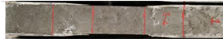
(d) Specimen 04 cracked within the grips
