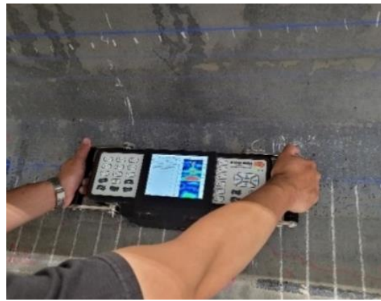
(d) Ultrasonic Tomography in Progress
