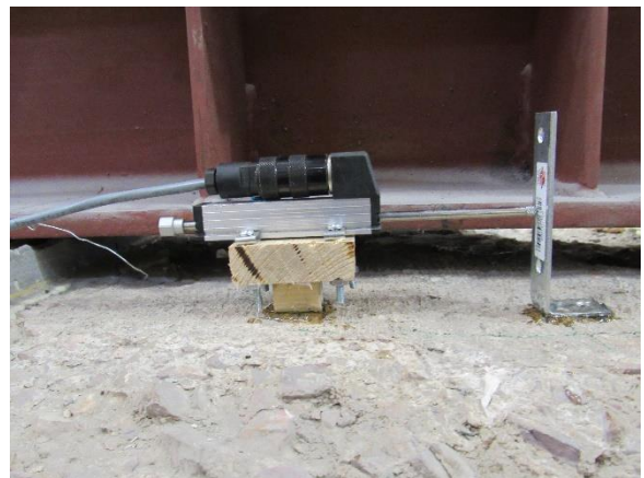
(d) LVDT on top of Flange for Rotations
