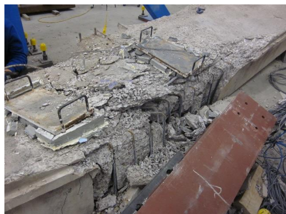
(d) Brittle Failure at Midspan
