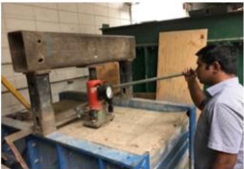
(d) Plate load test
