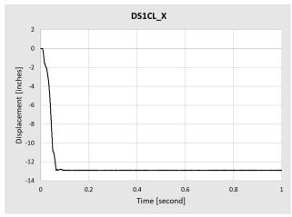
Figure B80. DS1CL\_X Displacement Data
