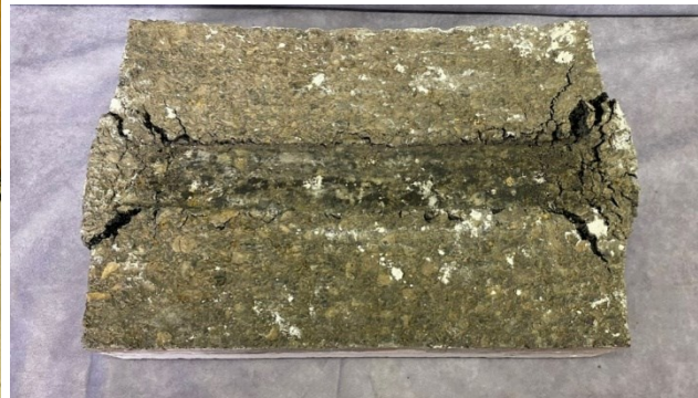
(d) Tested CLRS block sample with cracking
