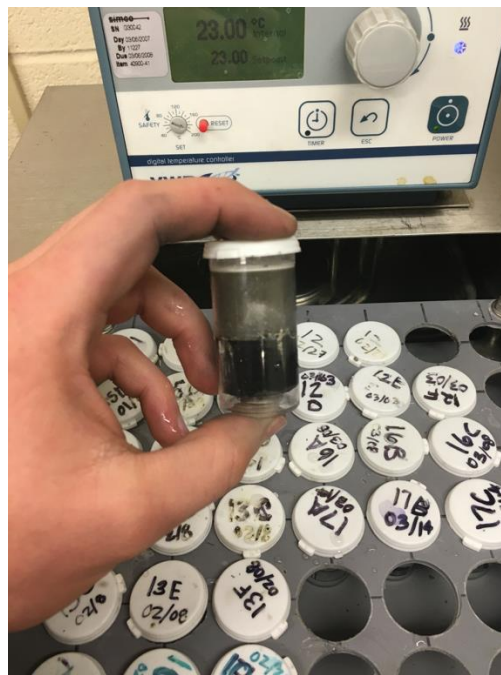
Figure 5-75: Mini restrained ring test
