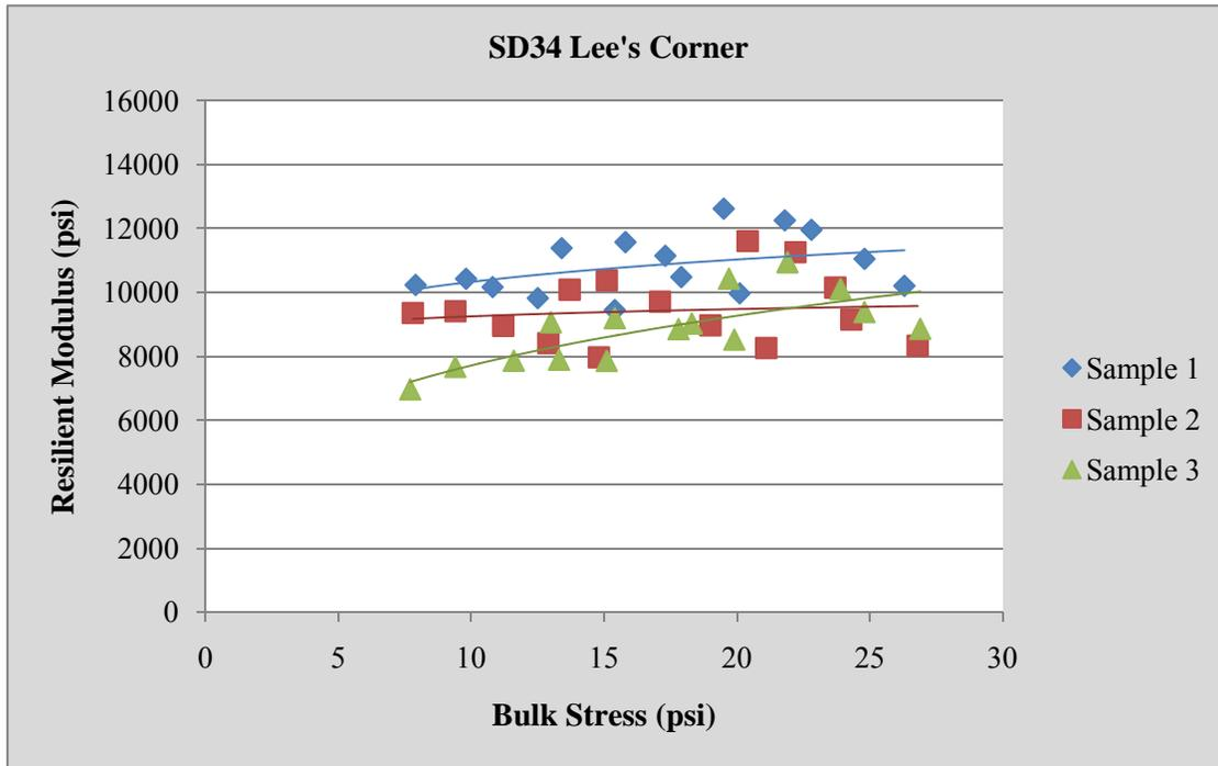
Figure 47: Resilient Modulus vs. Bulk Stress, SD34 Lee’s Corner
