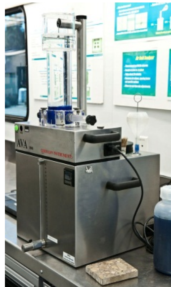
Figure 27 : The Air Void Analyzer (AVA)
