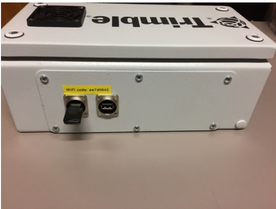
(d) Wi-Fi connection to Web UI on the Power Conversion Unit.
