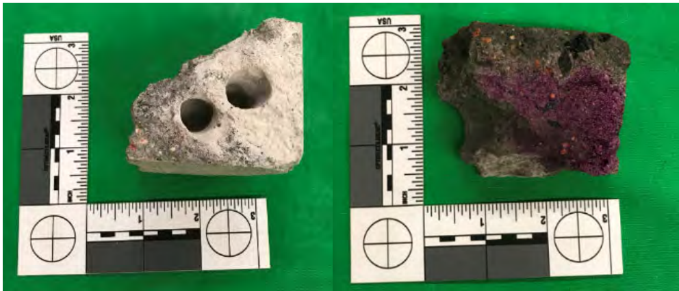
Fig. 26. O'Fallon Park core 4 pH test
