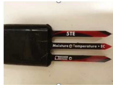
(d) Moisture/temperature sensor
