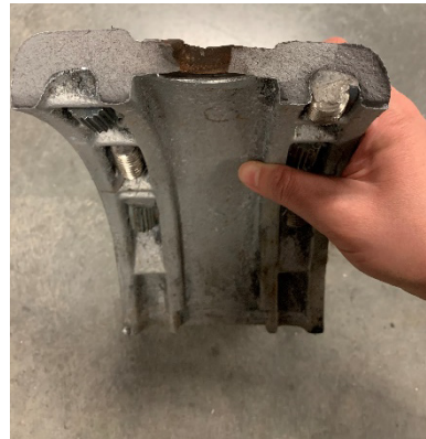
(b) Failure Surface of FAT-TENS13
