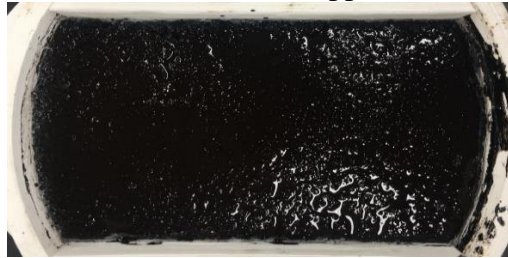
(d) Curing Tack Coat Layer
