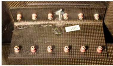
(d) Partially cracked shear tie at the corner (ST06)
