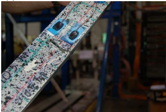
(d) 90.5T failure mode
