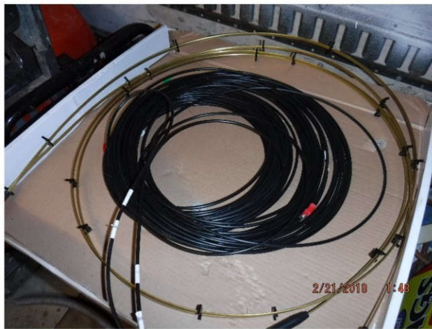
Figure 12. Photo. Polymer piezo sensor (FHWA 2018).
