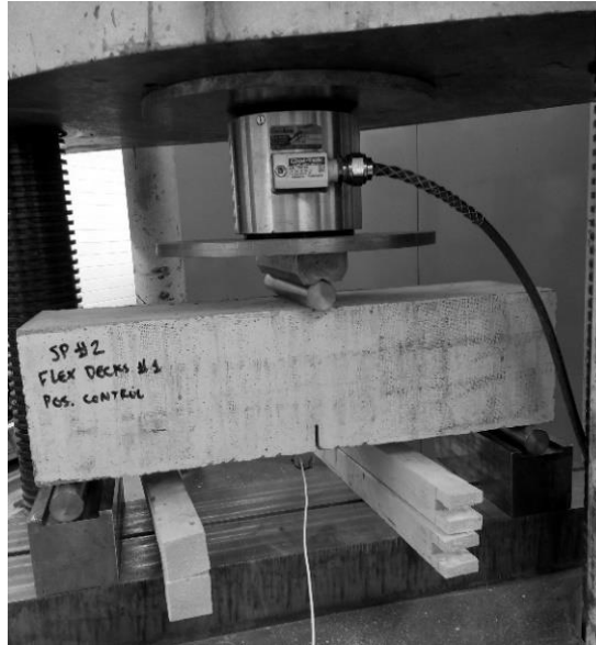
Figure 3.2.5 FRC mini beam test setup
