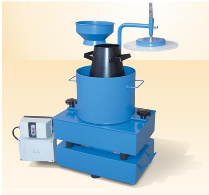
Figure 2-11 Test setup (EN 12350-3 2008)
