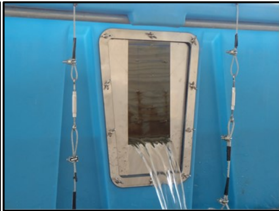
(d) installed weir plate
