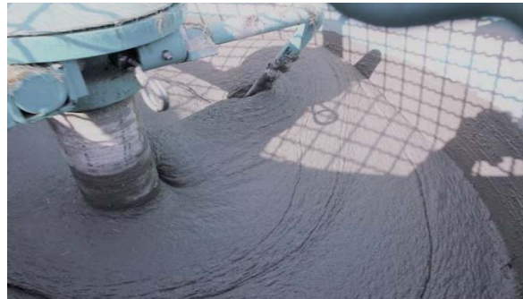
(d) Mix dispersion and homogenization
