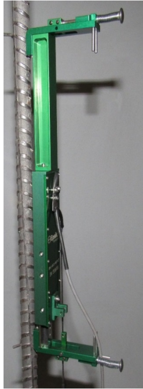
a. Bar extensometer
