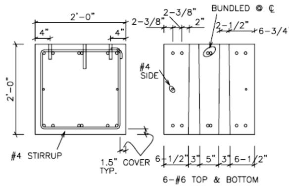
(d) Cap Beam Details for Double-Line Pocket
