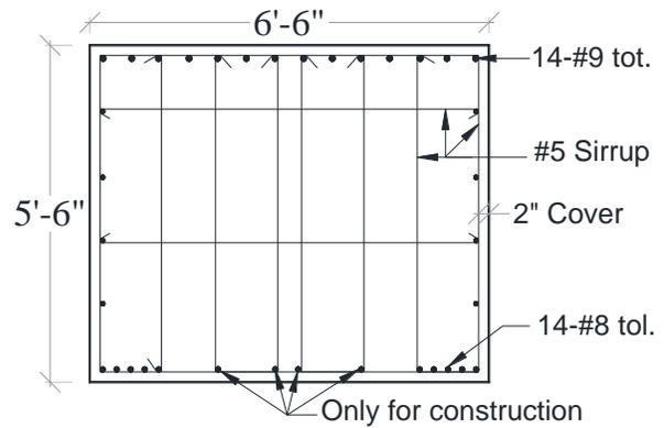
(d) Cap Beam Section w/o Pocket
