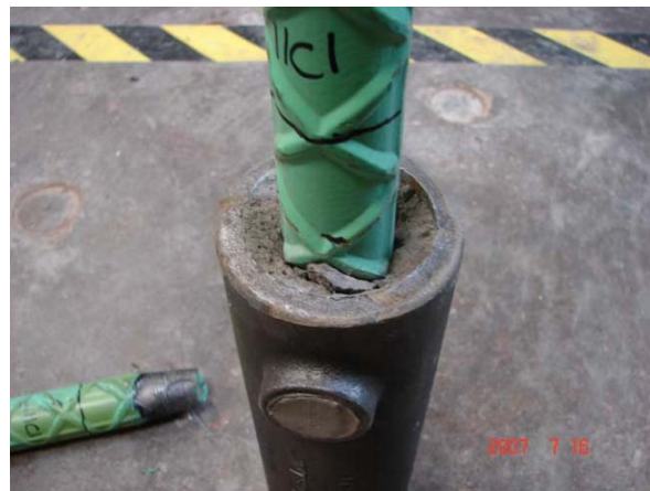
(d) Spalling in all three Tests
