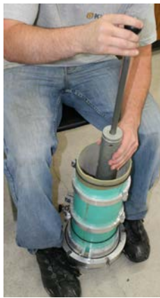
(d) Compacting aggregate
