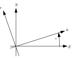
$$\begin{bmatrix} \Delta p_{u} \\ \Delta p_{v} \\ \Delta p_{w} \end{bmatrix} = \begin{bmatrix} \cos\alpha & \sin\alpha & 0 \\ -\sin\alpha & \cos\alpha & 0 \\ 0 & 0 & 1 \end{bmatrix} \begin{bmatrix} \Delta p_{E} \\ \Delta p_{N} \\ \Delta p_{U} \end{bmatrix} = \begin{bmatrix} \Delta p_{E} \cos\alpha + \Delta p_{N} \sin\alpha \\ -\Delta p_{E} \sin\alpha + \Delta p_{N} \cos\alpha \\ \Delta p_{U} \end{bmatrix}$$
