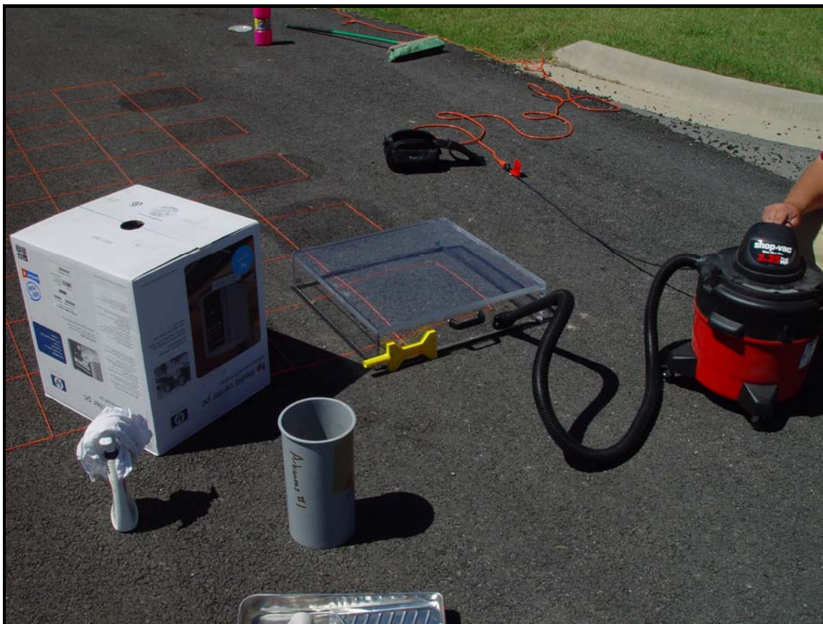
Figure 7. Kuss Vacuum Permeameter
