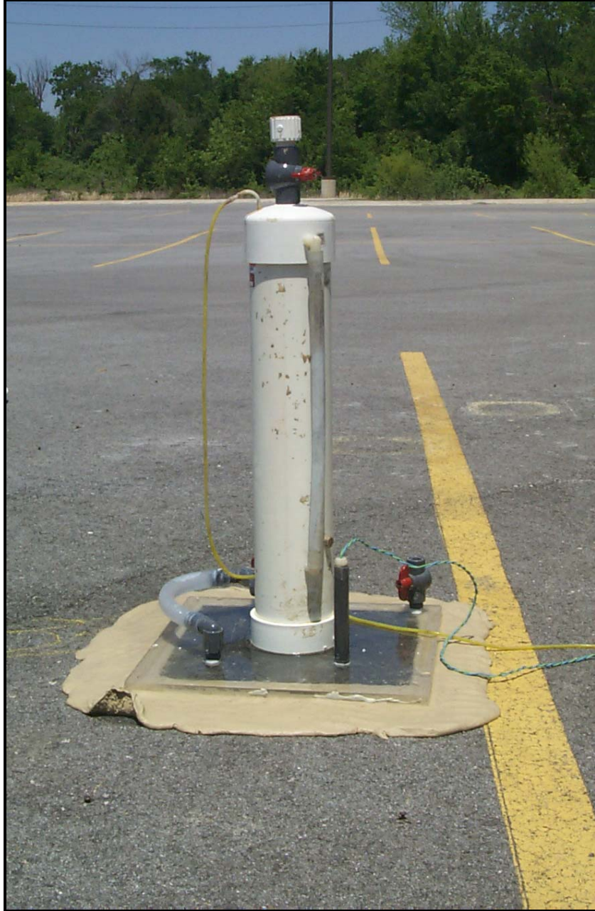
Figure 4. Kuss Field Permeameter
