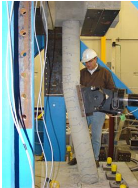
(d) Plastic Deformation in the Loaded Column
