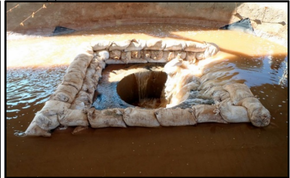
(d) square barrier failure
