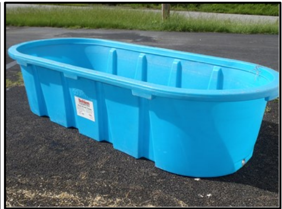
(d) 300 gal. equalizing tank
