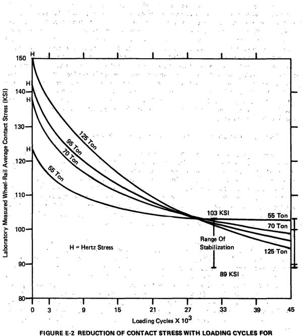
VARIOUS TONNAGE CARS IN LABORATORY SIMULATION
