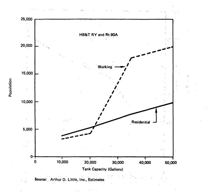
FIGURE 6-12 POPULATION EXPOSURE AS A FUNCTION OF TANK CAPACITY – LOWER DENSITY SITE
