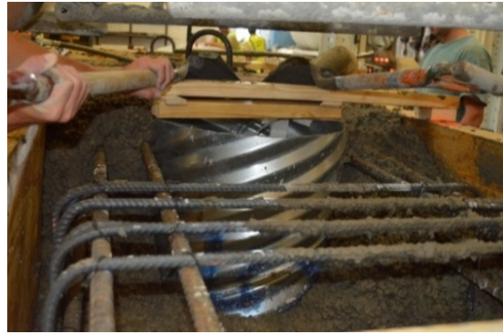
(d) Corrugated Steel Pipe Anchorage
