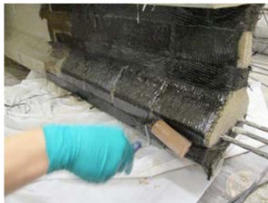
(d) Saturating CFRP anchors
