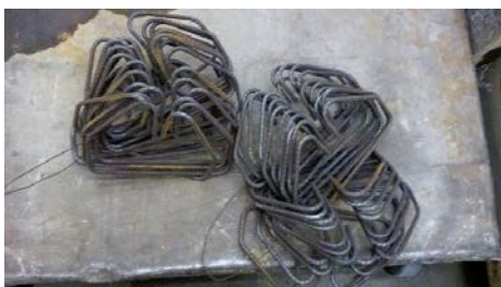
(b) Bent rebar
