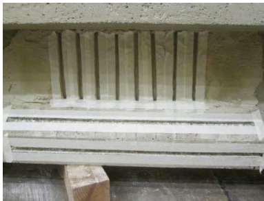
(d) Notches taped after cutting longitudinal notches
