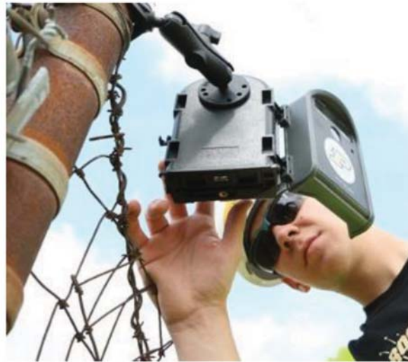
(d) Batteries are accessible from bottom
