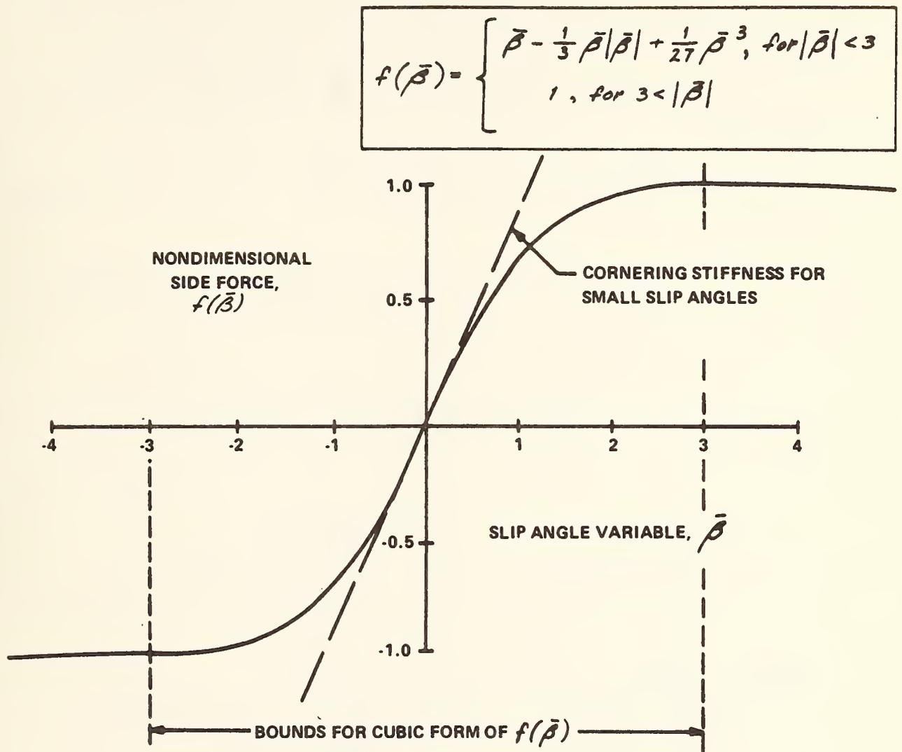
Figure 3-21. NONDIMENSIONAL TIRE SIDE-FORCE CURVE
