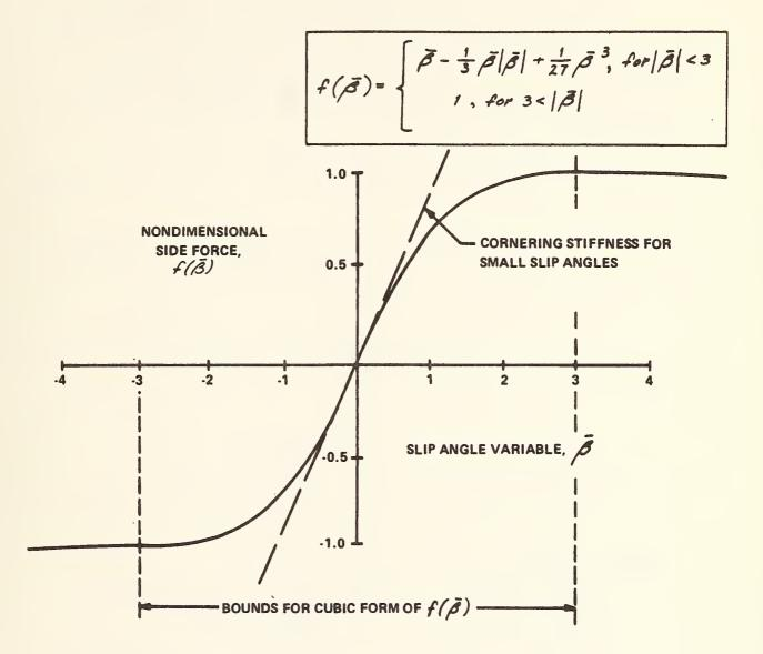
Figure 3-21 NONDIMENSIONAL TIRE SIDE-FORCE CURVE
