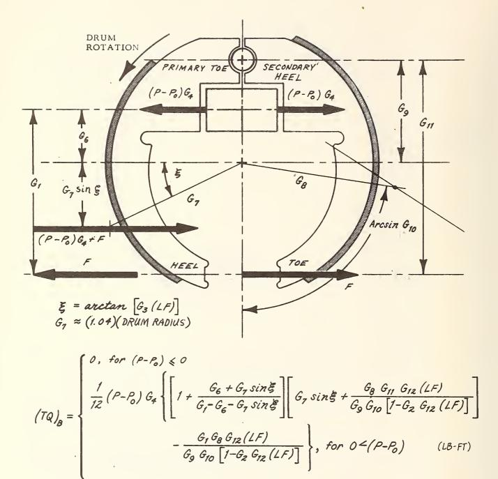
Figure 3.12 TYPE 3 BRAKE - BENDIX DUO SERVO
