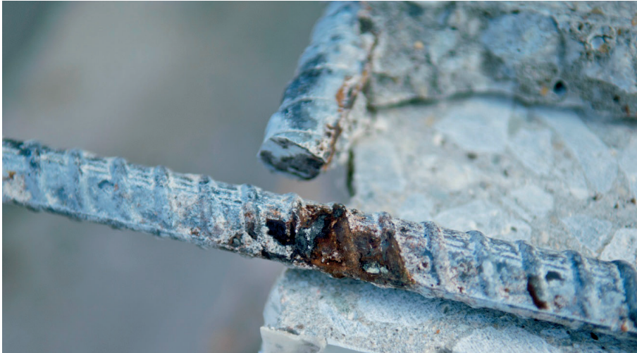
(d) Close up View of Corrosion on Bottom Black Bar
